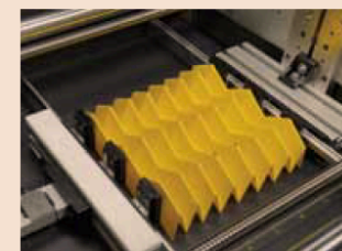
Il progetto S-Foam trae ispirazione dalle antiche tecniche giapponesi degli origami e dei kirigami, le arti di piegare e tagliare la carta. Esempio di prova di laboratorio eseguita su un modello di tassellazione Origami Eggbox
